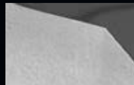
REM view of a diamond knife blade REM Vergrößerung einer Diamant-Messerklinge
