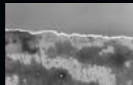
REM view of a common scalpel blade REM Vergrößerung einer gängigen Skalpellklinge
